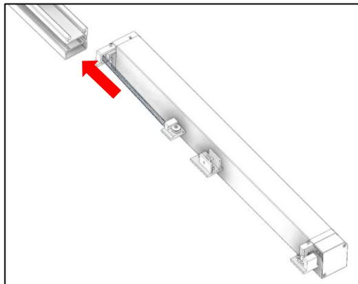
Motorbaugruppe (Pos. 1-4) in das Verbindungsprofil einschieben.
