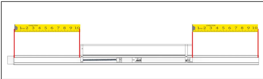
Baugruppe **mittig** auf dem Verbindungsprofil positionieren.
