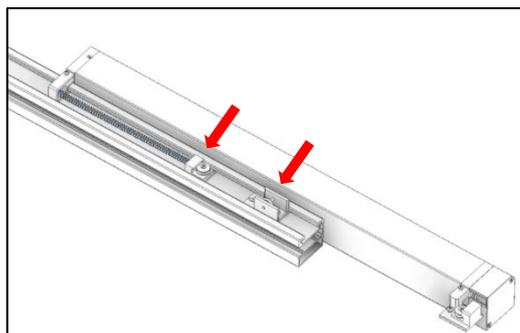
Darauf achten, dass der Rollenbock (Pos.4) und der Schlitten (Pos.3) sauber in das Verbindungsprofil mit eingeschoben werden.
