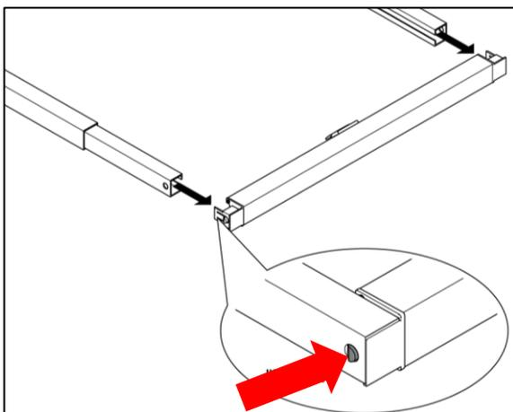
Rollo auf einen ebenen Untergrund legen und das Verbindungsprofil per Eindrücken der schwarzen Kunststoffrasten entfernen.
