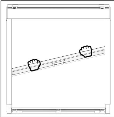
Griffleiste schräg nach unten ziehen und die Griffleiste dadurch aus den Führungsschienen ausfädeln.
