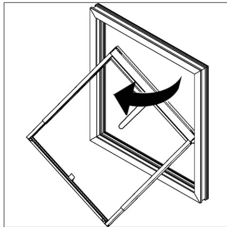
Durch Runterdrücken der oberen beiden Führungsschienen, kann das Rollo nach innen durch das Fenster geführt werden.
