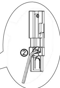
Beide Führungsschienen durch Eindrehen der unteren Klemmschraube (2) mit dem Innensechskantschlüssel fixieren!
