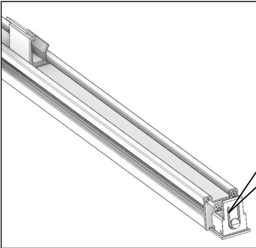
Schrauben der rechte Endkappe (von innen gesehen) lösen und die Endkappe der Verbindungsprofils demontieren.
