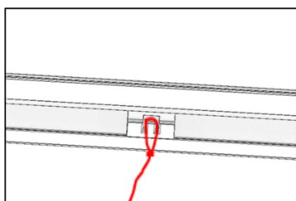
Stoff an der Griffleiste nach unten ziehen und die Seilschleife in das neue Griffelement (Pos.6) einhängen.
