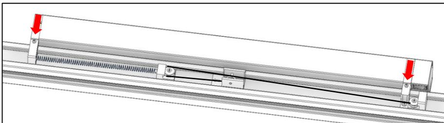
Die beiden Schrauben der Abdeckung herausschrauben.
