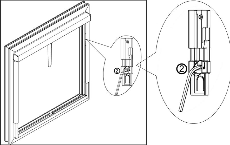
Beide Führungsschienen durch leichtes Lösen der unteren Klemmschrauben (2) entsichern.
