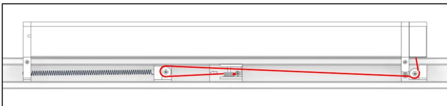
Seilschleife aus der Schraube aushängen und die Seilführung auf den korrekten Sitz prüfen (siehe Bild).
