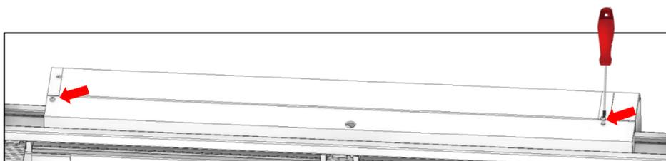
Abdeckblende (Pos.5) positionieren und mit den zwei Schrauben verschrauben.
