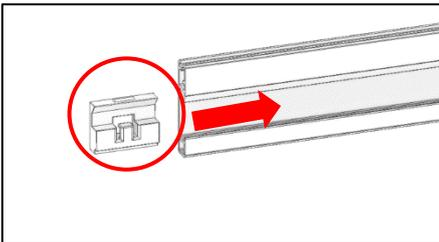
Neues Griffelement (Pos.6) einschieben und **mittig** in der Griffleiste positionieren.
