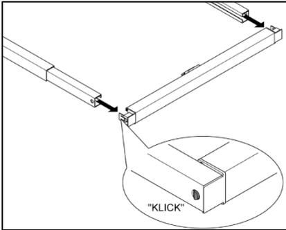
Verbindungsprofil inkl. Motor wieder in die beiden Führungsschienen einclippen
