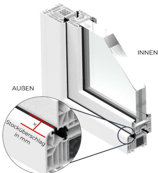
Der Stocküberschlag ist die äußerste Erhebung deines Fensterrahmenprofils. Bei Kunststofffenstern meist ca. 15-25mm.
